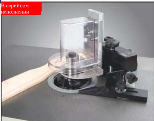
Все фрезерные станки оснащены защитным кожухом для дугового фрезерования.
