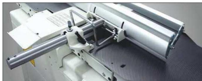
**Ножевой вал продольно-фрезерного станка TERSA**
