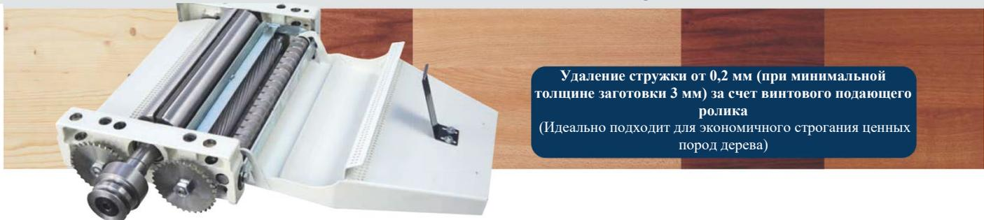
Удаление стружки от 0,2 мм (при минимальной толщине заготовки 3 мм) за счет винтового подающего ролика
