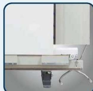
▶ Автоматически уклоняющаяся решетчатая рама для предотвращения врезания пильного полотна в полосу задней стенки
