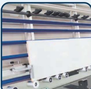
▶ Быстрая и легкая резка даже мелких деталей. Опора нижней плиты с индикацией размеров.
