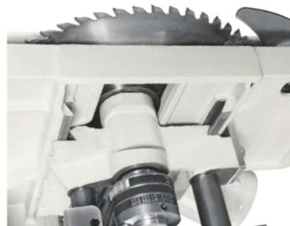
Регулировка высоты пильного агрегата осуществляется за счет прочной литой конструкции с направляющими типа «ласточкин хвост».
