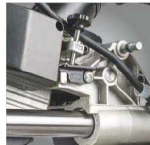
*Замок для ограничения глубины крышки*
