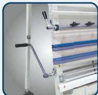
▶ Чтобы диск пилы не врезался в полосу задней стенки, решетчатую раму можно перемещать вручную
