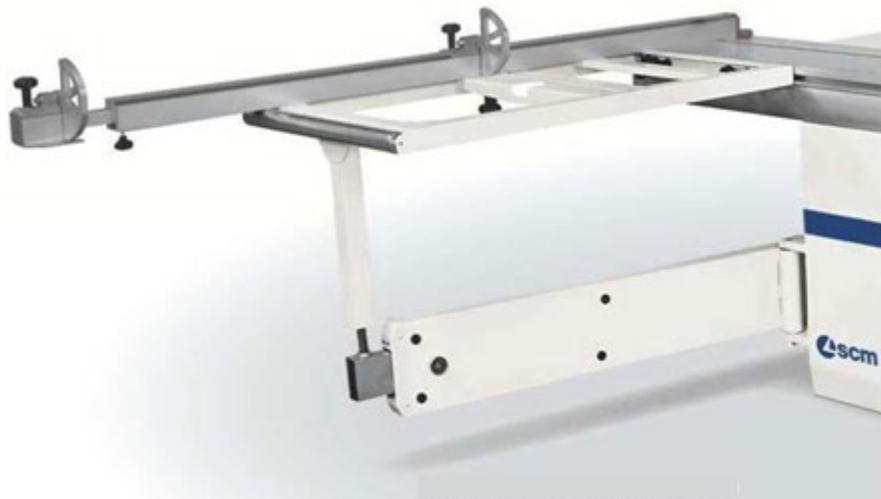
*На рисунке показан minimax si 400es 32 MA 3, доступный с форматной пильной кареткой из алюминия 2600 мм или 3200 мм, удлинителем стола, стандартной маятниковой защитой пильного полотна и опциональной встроенной функцией включения и выключения двигателей на пильной каретке*
