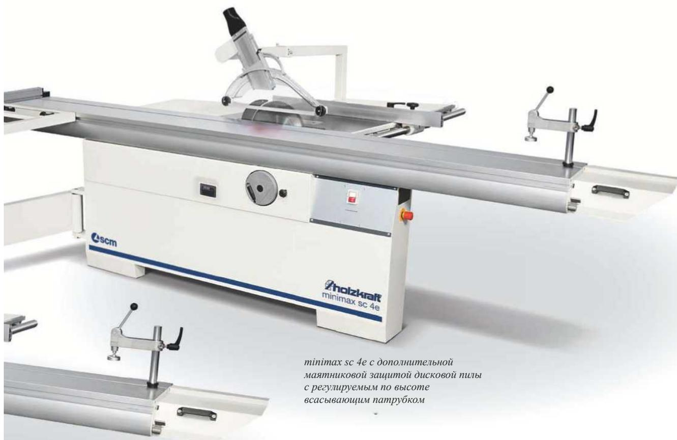
*minimax sc 4e с дополнительной маятниковой защитой дисковой пилы с регулируемым по высоте всасывающим патрубком*
