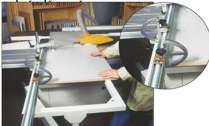
Стандартный удлинитель с поворотным рычагом позволяет форматировать большие панели размером до 2560 x 2300 мм.
