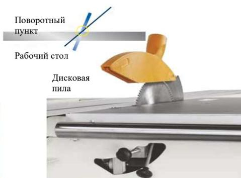
Регулировка высоты пильного блока осуществляется за счет прочной литой конструкции с направляющими типа «ласточкин хвост».
