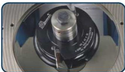
Большое отверстие в фрезерном столе также позволяет использовать более крупные правильные фрезы, а также инструменты для фрезерования шипов и пазов над и под столом.
