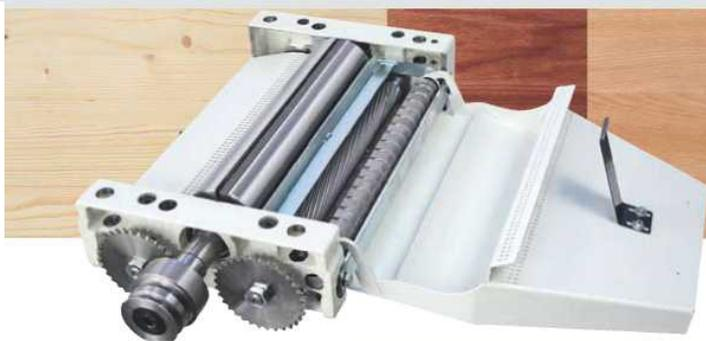
Удаление стружки от 0,2 мм (при минимальной толщине заготовки 3 мм) за счет винтового подающего ролика
