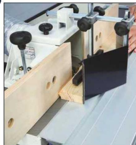
Фрезерный станок оснащен точно регулируемым фрезерным упором. Алюминиевая каретка дает возможность нарезать шипы без проблем.
