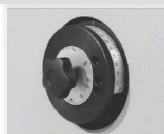
► **Стандартное управление МА, ручная регулировка угла гибки с помощью градуированного кольца на левой стороне станка**
