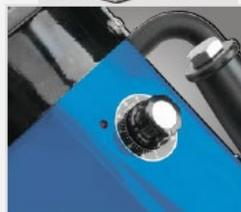
▶ Бесступенчатая регулировка количества оборотов позволяет обрабатывать различные материалы
