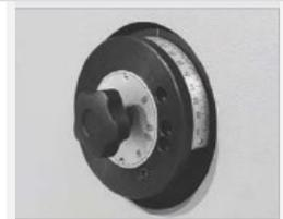
► **Стандартное управление MA**, ручная регулировка угла изгиба с помощью градуированного кольца на левой стороне станка
