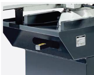
Зажимной рычаг для перестановки угла спереди
