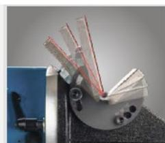
▶ 3 различных стандарта регулировки угла 15°, 30° и 45°
