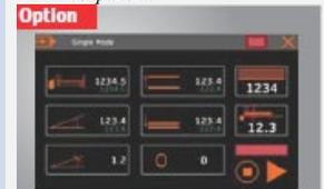
► **Опциональное управление Schneider NC2**, трехосное управление для цифрового ввода угла, ввод положения заднего упора и положения открытия прижимной траверсы с возможностью сохранения последовательности кромок, задний упор с электроприводом со стопорными пальцами, диапазон перемещения 15-1000 мм
