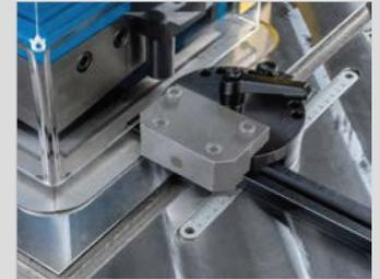
Упоры с перемещаемыми прижимными устройствами
