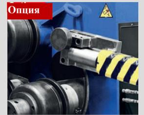
Опция: два боковых гидравлических направляющих ролика
