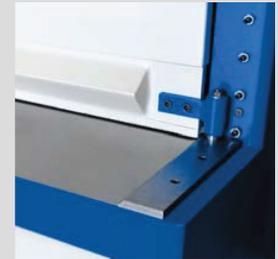
Тяжелые поперечины прижимного устройства с защищающими материал резиновыми вставками
