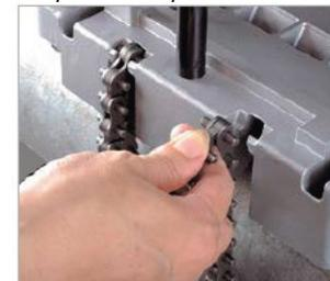
Крепление труб с помощью простой быстросажимной системы и цепи
