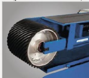
Контактные и приводные колеса больших размеров (рис. MBSM 150-200-2)
