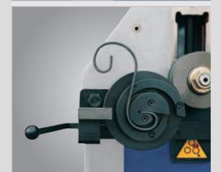
Применение спиральной гибки с optionальным гибочным инструментом
