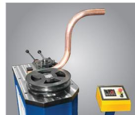
Возможен угол гибки до 180°
