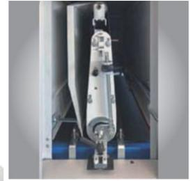
▶ Шлифовально-ленточный блок для обработки верхней поверхности и для полировки
