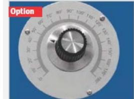
► **Дополнительный элемент управления PT 1** – ручная регулировка угла изгиба с помощью потенциометра, расположенного на передней части станка
