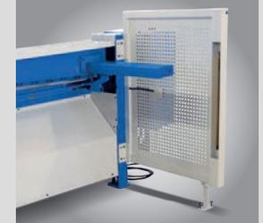
Заднее пространство защищено оптическим датчиком
