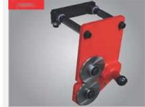
▶ Роликовые ножницы для листового металла толщиной до 0,8 мм
