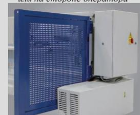
Защита заднего пространства с помощью боковых листов и оптического датчика
