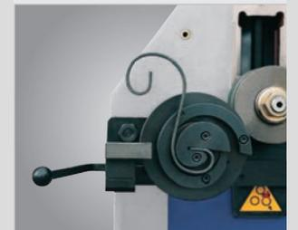
Применение спиральной гибки с опциональным гибочным инструментом
