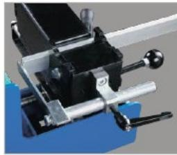
▶ Переставляемый без помощи инструмента продольный упор (только при 90°)
