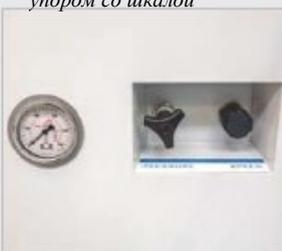
▶ Регулируемое гидравлическое давление
