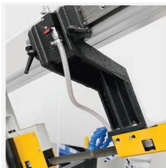
Станки с поворотной рамой, ширина пильной ленты 34 мм, со стандартной вертикальной направляющей пильной ленты
