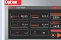
► **Опциональное управление Schneider NC2**, трехосное управление для цифрового ввода угла, ввод положения заднего упора и положения открытия прижимной траверсы с возможностью сохранения последовательности кромок, задний упор с электроприводом со стопорными пальцами, диапазон перемещения 15-1000 мм
