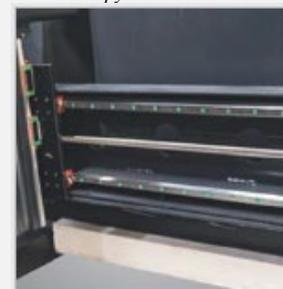
▶ Ось X, приводимая в движение шарико-винтовой парой, движется по двойным линейным направляющим
