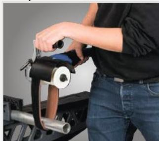
Полирование круглой стали с помощью KlettVlies даже, к примеру, на уже смонтированных перилах из инструментальной стали
