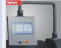
► **Опциональное ЧПУ-управление с 3D-графикой**, профили указываются оператором на большом 19-дюймовом сенсорном экране, все положения осей и последовательность изгибы рассчитываются системой управления, моторизованный задний упор со стопорными пальцами, диапазон перемещения 15-1000 мм
