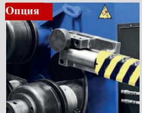
**Опция**: два боковых гидравлических направляющих ролика
