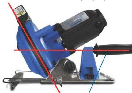
▶ Ручку можно переустановить для резки под углом, чтобы пилу можно было безопасно направлять параллельно плоскости резки.
