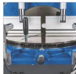
Бесступенчатая регулировка угла скоса
