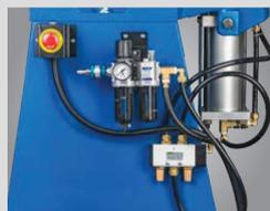
Пневмоблок пневматической части
