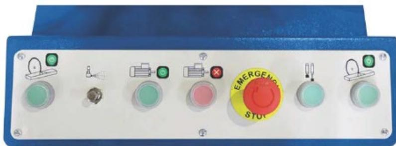
Элементы управления слева направо: выключатель пуска пилы слева, минимальное количество смазки, двигатель включен, двигатель выключен, АВАРИЙНОЕ ОТКЛЮЧЕНИЕ, натяжение, выключатель пуска пилы справа
