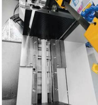
Станки с поворотной рамой с шириной пильной ленты 34 мм, включая сменные срабатываемые пластины на столе укладки материала
