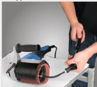
Простая фиксация шлифовальных цилиндров с помощью накачивания резиновой трубки
