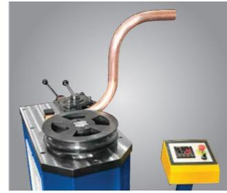
Возможен угол гибки до 180°
