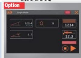
► **Опциональное управление Schneider NC1**, угол изгиба, задний упор и открытие прижимной траверсы через сенсорный экран на ЧПУ, моторизованный задний упор со стопорными пальцами, 15-1000 мм, последовательность складывания может быть сохранена
