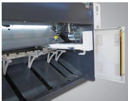
Защита заднего пространства с помощью боковых листов и оптического датчика
