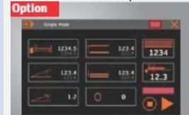
► **Опциональное управление Schneider NC2**, трехосное управление для цифрового ввода угла, ввод положения заднего упора и положения открытия прижимной траверсы с возможностью сохранения последовательности кромок, задний упор с электроприводом со стопорными пальцами, диапазон перемещения 15-1000 мм
