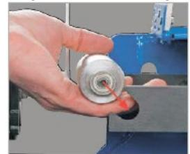
▶ Благодаря оптимизированному держателю простая и быстрая смена шлифовального ролика без помощи инструмента
