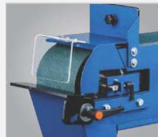
Простая регулировка хода ленты посредством регулировочного винта
