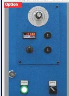
► **Дополнительное управление PUD** с цифровым дисплеем, ручная регулировка угла изгиба и регулируемый задний упор с электроприводом
