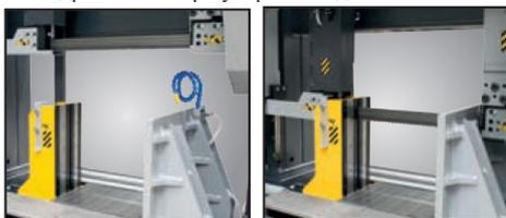
▶ Передняя направляющая ленты движется параллельно подвижной губке тисков - как результат высокоточная проводка пильной ленты
