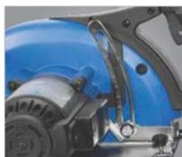
▶ несложная и быстрая регулировка глубины резания с помощью точной и легко читаемой шкалы
