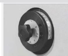
► **Стандартное управление МА**, ручная регулировка угла сгиба с помощью градуированного кольца на левой стороне станка
