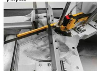
**Вращающаяся тарелка на шариковых опорах с дополнительными срабатываемыми пластинами на пильном зоре и 15° фиксацией** **Ваша выгода:** Более точный угол резки, лучшая опора для заготовки, не требуется смена срабатываемых пластин
