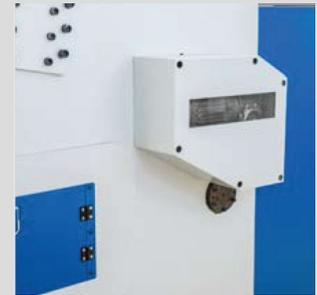
Перестановка зазора резки с моторным приводом посредством системы управления
