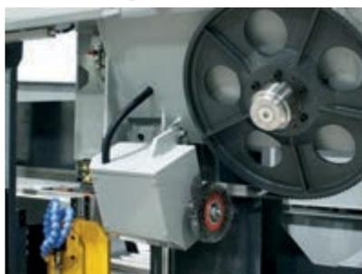
▶ Щетка для стружки с моторным приводом
