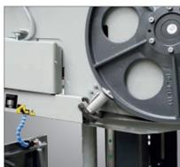
Щетка для уборки стружки с приводом для очистки и содержания в исправности пильной ленты
