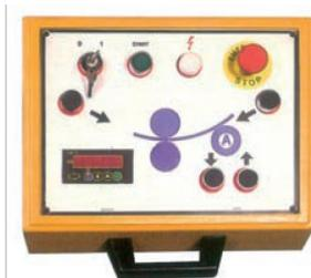
Панель управления с цифровым индикатором для бокового валика, подача бокового валика с моторным приводом и кнопка подачи материала вместо ножной педали (опция)
