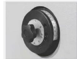
► **Стандартное управление МА**, ручная регулировка угла изгиба с помощью градуированного кольца на левой стороне станка
