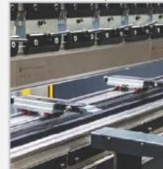
▶ Задний упор X/R с ручными осями Z
