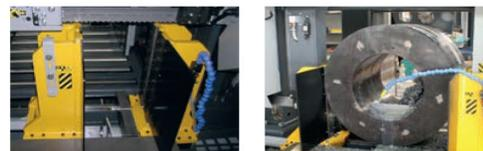
► Зажим материала до и после реза с помощью раздвоенных тисков
