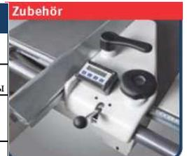
▶ С цифровым индикатором ширины пропила на параллельном упоре, арт. №: 5516000
