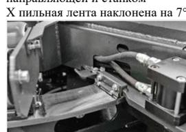
**Гидравлический зажим поворотной тарелки**
