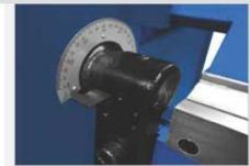
▶ простая ручная регулировка угла изгиба с помощью упора со шкалой
