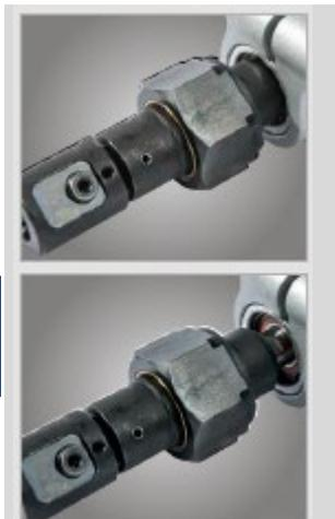
Реверсивный механизм для короткой продолжительности обработки: давление на шпиндель запускает медленный правосторонний ход, а вытягивание – автоматический ускоренный обратный ход
