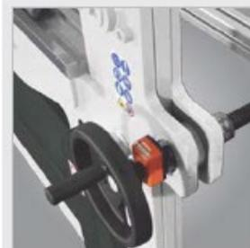
▶ *Регулировка заднего упора с помощью маховика со счетчиком*
