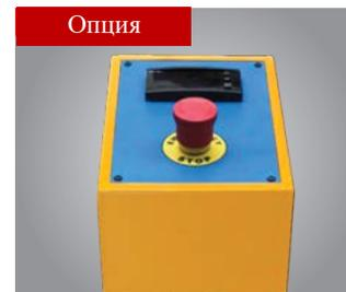
Пульт управления с цифровым индикатором и подачей бокового валика с помощью двигателя
