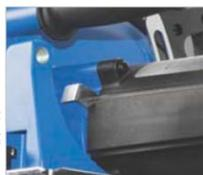
▶ быстрая смена пильного полотна благодаря стопорному штифту и шестерни
