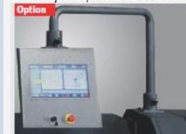
► **Опциональное ЧПУ-управление с 3D-графикой**, профили указываются оператором на большом 19-дюймовом сенсорном экране, все положения осей и последовательность изгиба рассчитываются системой управления, моторизованный задний упор со стопорными пальцами, диапазон перемещения 15-1000 мм
