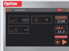
► **Опциональное управление Schneider NC1**, угол изгиба, задний упор и открытие прижимной траверсы через сенсорный экран на ЧПУ, моторизованный задний упор со стопорными пальцами, 15-1000 мм, последовательность складывания может быть сохранена
