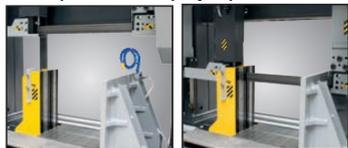
▶ Передняя ленточная направляющая движется параллельно подвижной щечке тисков - благодаря этому высокоточная проводка пильной ленты
