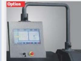
► **Опциональное ЧПУ-управление с 3D-графикой**, профили указываются оператором на большом 19-дюймовом сенсорном экране, все положения осей и последовательность гибки рассчитываются системой управления, моторизованный задний упор со стопорными пальцами, диапазон перемещения 15-1000 мм
