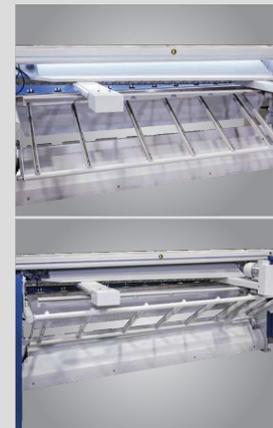
Пневматическое устройство фиксации листа с рычагом-избирателем направления решетки. Оператор может выбрать, упадет ли отрезок в заднем пространстве или на стороне оператора
