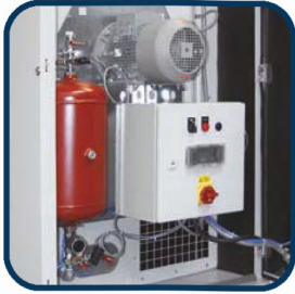
От модели RLA 2501 P с интегрированной пожарной автоматикой, испытанной согласно GS-HO-07
