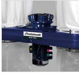
Поворачиваемый на 180° аспирационный блок способствует ведению аспирации снизу или сверху (на рисунке показан ASA 7703)
