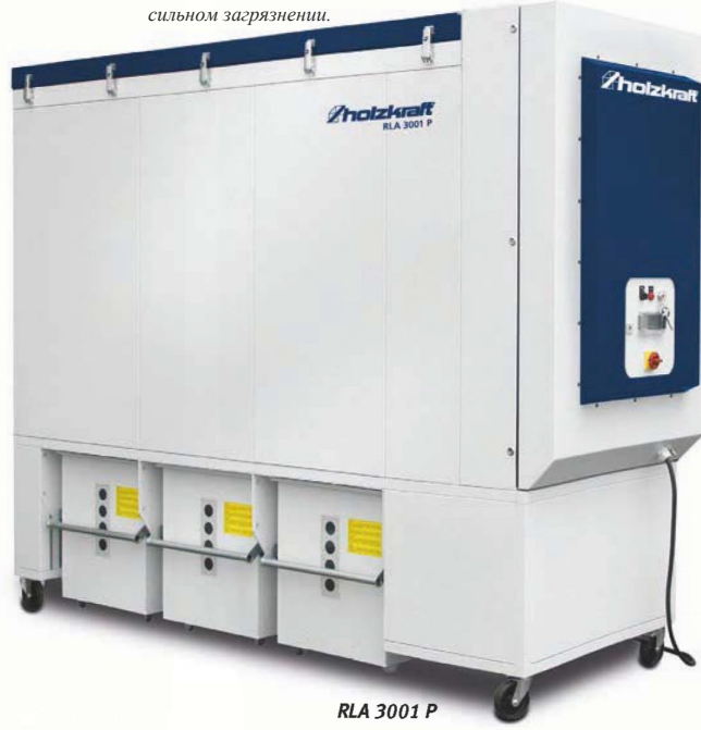
Очистка осуществляется импульсными толчками сжатого воздуха, очищающими фильтр изнутри наружу. Вызываемая этим механическая деформация фильтра оптимизирует степень регенерации при сильном загрязнении.
