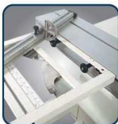
▶ Стрела с регулируемым углом телескопического поперечного упора ▶ С градусной шкалой
