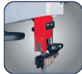
Верхние и нижние направляющие пыльного полотна с элементами из бронзы
