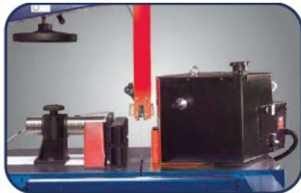
VSA 260 CPM: пневматический с бесступенчатой скоростью подачи Медные ролики для подачи материала
