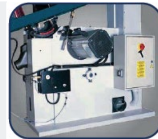
Установка стола под углом зубчатой рейкой и автоматический выключатель звезда-треугольник
