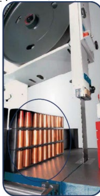
VSA 260 CPM: пневматический с бесступенчатой скоростью подачи Медные ролики для подачи материала
