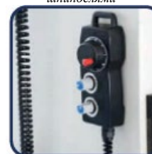
Прецизионное управление точным позиционированием тремя поворотными ручками: верхняя — для позиционирования, средняя — для выбора оси и нижняя — для регулировки величины шага 1,10 или 100
