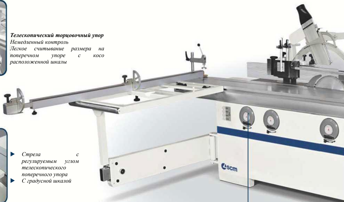
С прочными маховиками со встроенной градусной индикацией
