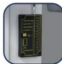
Встроенная в раму станка индикация зажима пильного полотна для различной ширины полотна
