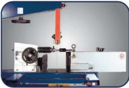
VSA 235: Самоцентрирующийся автоподатчик
