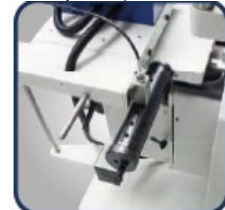
▶ Устройство для высверливания отверстий под дюбели с шагом фиксатора 16 / 22 / 25 / 32
