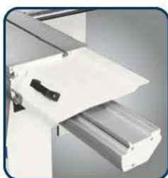
Пильная каретка с системой контакта с шариками ▶ Из анодированного алюминия ▶ Направляющие из закаленной и шлифованной стали F550S, на 15% тверже обычной стали ▶ Направляющие соединены заклепками и не приклеены ▶ С легким ходом, малошумный и надежный ▶ Десятилетняя гарантия HOLZKRAFT на износ закаленных направляющих (Условия гарантии можно найти на www.stuermer-maschinen.de или запросить в компании «Stürmer Maschinen GmbH»)
