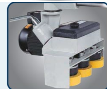
▶ Возможность индивидуальной регулировки в горизонтальном и вертикальном положении для оптимальной подачи
