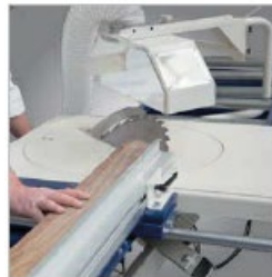
Комбинированное пиление с наклоном и под углом
