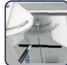
▶ Рабочий стол поворачивается с обеих сторон на 60 град
