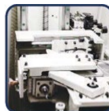
Сверлильный агрегат с ползуном и четырьмя горизонтальными шпинделями
