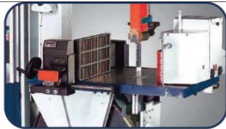
VSA 21 CP: пневматическое открывание VSA 260 CPM: пневматический с бесступенчатой Скорость подачи
