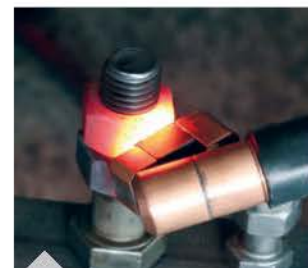
Нагрев гайки с помощью наклонной фокусной катушки
