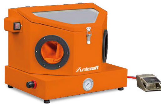
SSK 1.5 ▶ Регулировка рабочего давления с помощью реле давления с манометром ▶ Управление потоком воздуха с помощью ножной педали ▶ Люминесцентная лампа 12 В с блоком питания 230 В и наружным выключателем ▶ Встроенное вытяжное устройство со сменным воздушным фильтром
