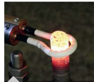
Нагрев гайки с помощью наклонной фокусной катушки
