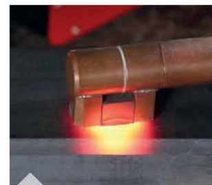
Нагрев конструктивной детали с помощью боковой фокусной катушки
