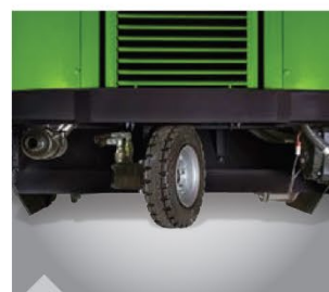
Привод через заднее ведущее колесо позволяет выполнять безопасные перемещения на поворотах очень малого радиуса
