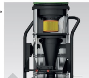
Многоступенчатая камерная фильтровальная система обеспечивает защиту фильтров от загрязнения и благодаря этому способствует повышению мощности всасывания
