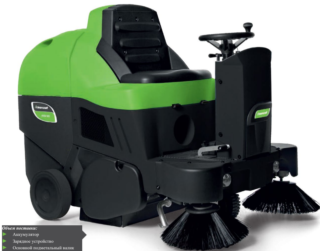
Замена центральной и боковых щеток без инструментов
