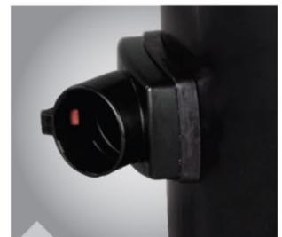
Циклонный входной патрубок Патрубок для впуска воздуха расположен по касательной к корпусу для создания циклонного эффекта (предварительного отделения загрязнений)
