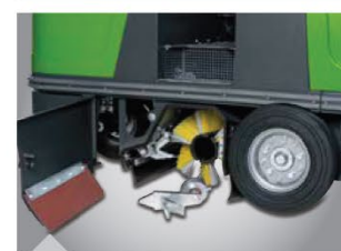
Замена основного подметального валика и боковой щетки без инструментов
