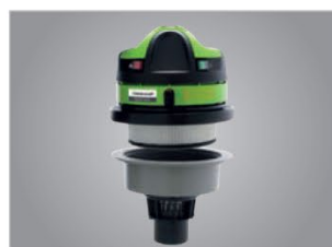
Защитный вкладыш с встроенным поплавком предотвращает при влажной уборке переполнение бака и тем самым защищает от повреждения фильтр и всасывающие двигатели
