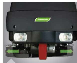
Чистящие щетки с - автоматическим втягиванием при столкновениях
