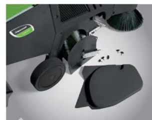
Замена центральной и боковых щеток без инструментов
