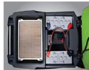
Два аккумулятора на 12 В обеспечивают 4 часа непрерывной работы без вредных выделений
