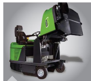
Опорожнение мусорного контейнера с помощью гидравлики на высоте 1,4 м
