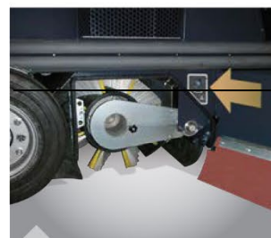
Замена основного подметального валика без инструментов. Нажим и высота основного подметального валика регулируются независимо друг от друга
