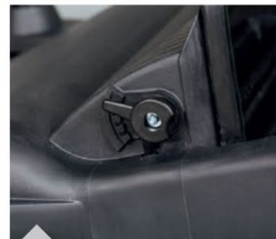
НКМ 800: Удобная регулировка высоты подметального валика без инструментов
