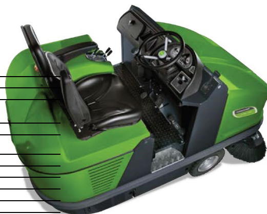
Опорожнение мусорного контейнера с помощью гидравлики на высоте 1,4 м
