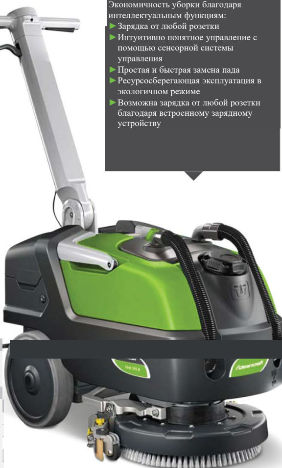
Тщательная и экономная уборка Моющий раствор подается насосом с постоянным расходом. Распределение раствора происходит от центра щетки, что обеспечивает равномерность очистки даже при незначительном расходе воды
