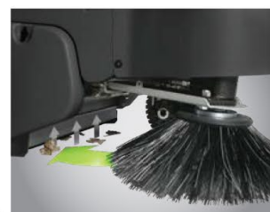
Боковые щетки с электрическим механизмом всасывания пыли
