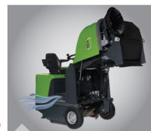
Опорожнение мусорного контейнера с помощью гидравлики на высоте 1,4 м
