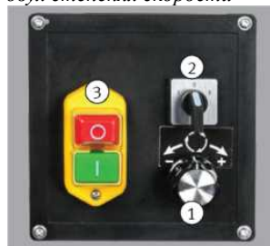
Регулирование числа оборотов в двух степенях скорости
