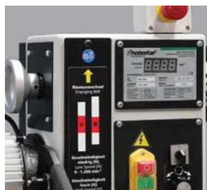
Регулирование числа оборотов в двух степенях скорости
