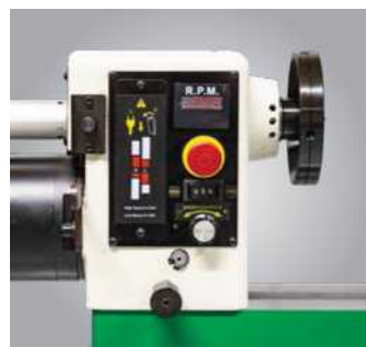
Встроенная цифровая индикация числа оборотов
