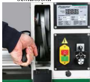
Смена ступени передачи без использования инструментов легкой переустановкой клинового ремня
