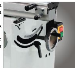
Маховик для регулировки пильного полотна по высоте
