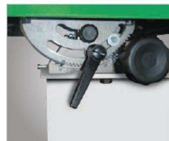
Стол станка можно наклонять на качающемся приспособлении от 0° до 45°
