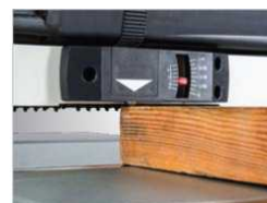
Механическая индикация удаления стружки
