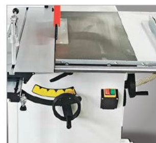
▶ Высота и поворот пильного полотна удобно регулируются маховиками
