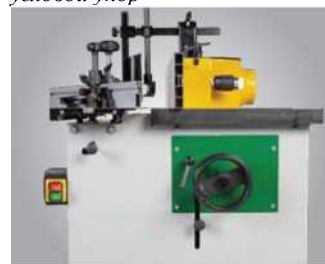
Маховик для регулировки по высоте
