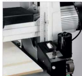
Регулирование шлифовального модуля по высоте отображается на шкале
