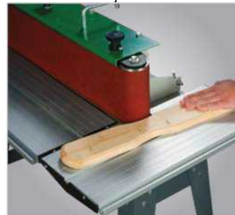
Простое шлифование радиусов
