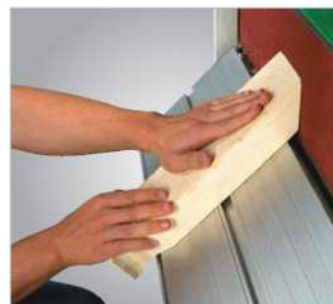
Соединения под углом до 45° за счет наклона продольного стола
