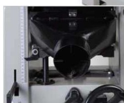
Регулирование высоты стола маховиком по шкале и числовой индикацией
