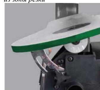
Наклон стола точно регулируется по шкале
