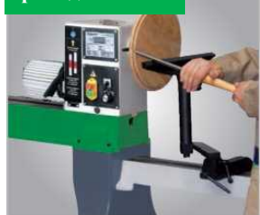
Смена ступени передачи без использования инструментов легкой переустановкой клинового ремня
