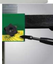
Регулирование рабочим рычагом удаления стружки
