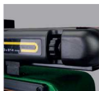
BTS 151: Быстрая смена шлифовальной ленты без инструмента за счет быстрозажимного приспособления
