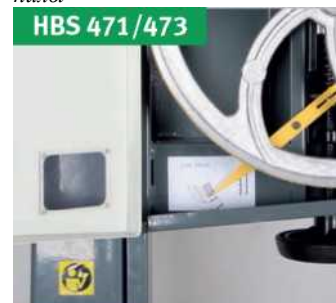
Натяжение пильного можно контролировать снаружи через встроенное в дверь окно
