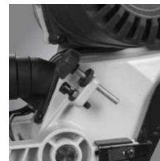
Двойное регулирование ограничения глубины обработки
