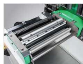
Регулирование рабочим рычагом удаления стружки
