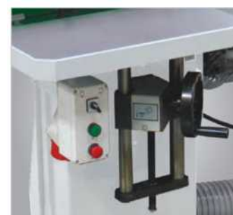
Регулируемый по высоте шлифовальный стол для использования всей ширины абразивной ленты
