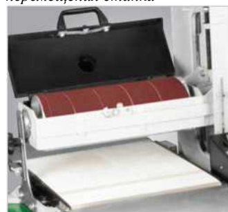
Простая и быстрая смена шлифовального полотна
